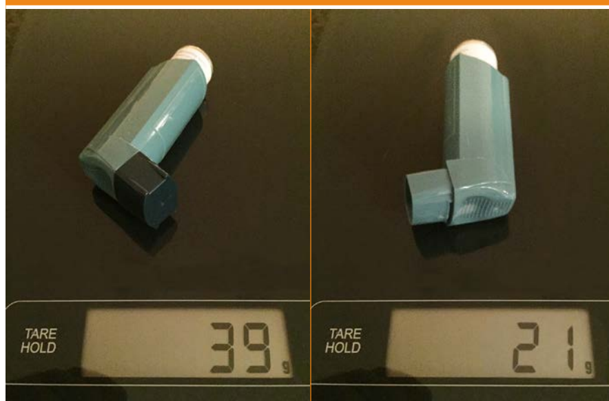
Abbildung 1. Gefülltes und leeres Dosieraerosol auf der Küchenwaage
