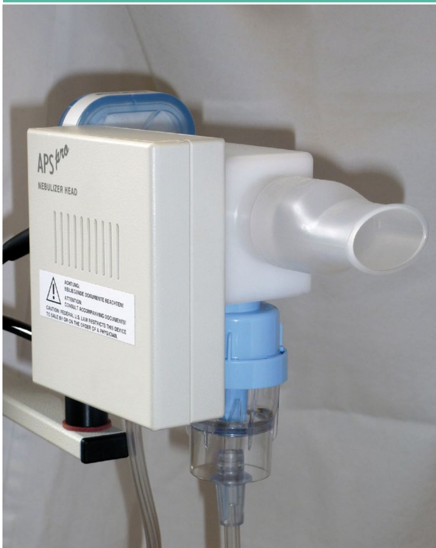
Abbildung 4: Vernebler mit Mundstück und Filter sowie Verneblerkopf zur Integration in einen Spirometrie/Bodyplethysmografie-Messplatz
